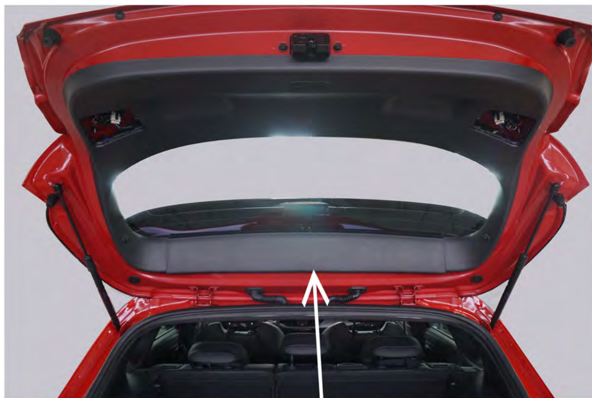
Mittlere Verkleidung ausbauen.
